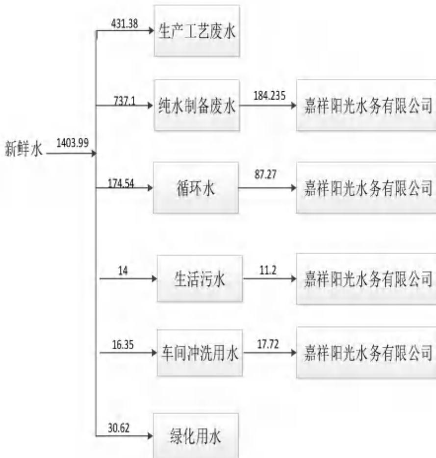
图 3.4-2 一期项目水平衡图（单位：m<sup>3</sup>/d）
