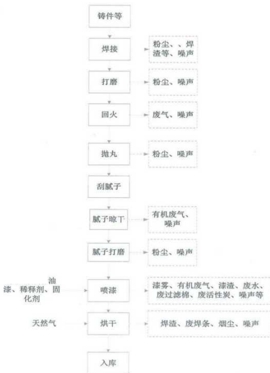
图 7 机床零部件工艺流程及产污环节图
